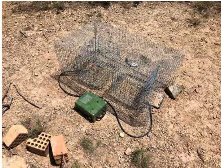
Foto 2. Sistema de gàbia trampa amb el sistema BIRDLOG instal·lat. Cada cop que una tórtora anellada amb PitTag entra a les gàbies amb menjar, el sistema enregistra l'ID de l'individu.
